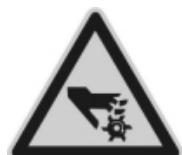
**Varování! Třísky s ostrými hranami!** Neodstraňujte nikdy třísky holou rukou. Vzniká nebezpečí zranění. Používejte pro odstranění třísek vhodný háček na odstranění třísek. Když je zařízení vypnuté, můžete třísky odstranit štětcem nebo smetáčkem. **Při čištění nepoužívejte nikdy tlakový vzduch!**
