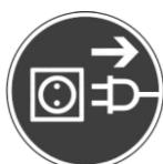
**Odpojte stroj při údržbě, výměně dílů a čištění z elektrické sítě.** Ujistěte se, že se vypínač nachází v pozici „VYP“ dříve, než zařízení opět napojíte na elektrický proud. Když není zařízení více používáno, vytáhněte zástrčku ze zásuvky
