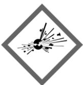
Nepracujte se strojem v prostředí, **kde hrozí nebezpečí výbuchu**, kde se nacházejí plyny, prach nebo hořlavé kapaliny. Jiskry, které u stroje vznikají, mohou zapálit prach, hořlavé kapaliny nebo páry.
